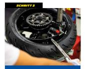
Die Montage des Reifens auf die Felge mit geeigneten Hebeln durchführen und an der Stelle des Ventils beenden
