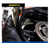
Brechen Sie die Dichtung zwischen den Reifenwülsten und der Felge auf und schmieren Sie die Felge und die Wülste
