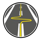
Auch Kick-Back genannt, ist eine plötzliche, heftige und sehr schnelle Hin- und Herbewegung des Lenkers, die in der Beschleunigungsphase auftritt und von einer Fahrbahnunebenheit ausgelöst wird (Absatz, Trennfuge, Bodenwellen, Schlaglöcher).
