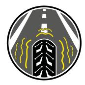
Die Symptome von nicht erfolgtem Auswuchten zeigen sich in Form von Vibrationen im Geschwindigkeitsbereich von 90 km/h bis 130 km/h an Vorderrad und Gabel. Das Auswuchten des Vorderrades ist unbedingt erforderlich, für das Hinterrad wird das Auswuchten empfohlen.
