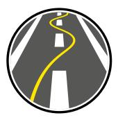
Auch Hochgeschwindigkeitspendeln genannt, ist eine schlangenlinienförmige Bewegung mit unterschiedlicher Amplitude, die bei Geradeausfahrt oder in schnellen Kurven ab einer Geschwindigkeit von ca. 140 km/h auftritt.
